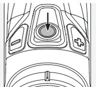
Door indrukken van de meetknop verschijnt een lichtcirkel, het richtpunt, en wordt de meetfunctie geactiveerd. Het loslaten van de meetknop activeert de meting, het richtpunt
