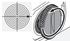
b) ... en cas d'impact vers la droite, dans le sens inverse des aiguilles d'une montre conformément à la valeur de correction du point
