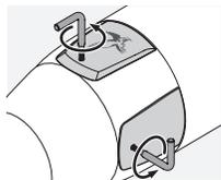
2. Svitare i cappucci della regolazione laterale e dell'altezza con il cacciavite Torx (TX 6) in dotazione. Una volta aperti, è possibile procedere alla regolazione laterale e dell'altezza con l'utensile di regolazione.
