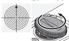
b) ... en cas d'impact haut, dans le sens inverse des aiguilles d'une montre conformément à la valeur de correction du point
