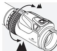
Genom att vrida ringen på förstoringen 180° kan du steglöst ställa in önskad förstoring. Skalan på ringen gör det enkelt och bekvämt att avläsa inställningen. För att lättare kunna orientera sig, har det mjuka, räfflade överdraget på inställningsringen en näsa. När förstoringen ändras anpassar sig siktpunktens och vindriktpunkternas position nästan samtidigt.
