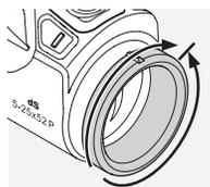
Girando semplicemente il compensatore di diottrie è possibile effettuare una regolazione individuale ottenendo così un'ottimale nitidezza del reticolo. Girare dapprima il compensatore di diottrie completamente verso sinistra (in senso antiorario) e poi verso destra, finché il reticolo non mostrerà la nitidezza ottimale. Una volta che il reticolo è nitido, anche il display lo sarà.
