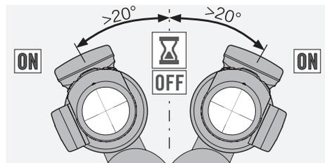
L'éclairage du réticule et l'écran s'éteignent au bout de 40, 60 ou 80 secondes (ce laps de temps peut être pré-réglé dans l'app). 10 secondes auparavant apparaît un symbole d'avertissement ; pour prolonger la durée de l'affichage de l'écran et le laps de temps réglé, vous devez appuyer sur la touche +/- ou basculer le dS de 20 degrés vers la droite ou la gauche. Si l'écran s'est éteint, appuyez à nouveau sur le bouton de mesure pour le réactiver.
