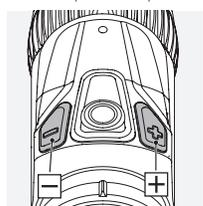
После включения подсветки прицельной марки можно настроить яркость с помощью кнопок «+/-», а также выбрать режим подсветки из 64 доступных уровней яркости. Для быстрой настройки оптимальной яркости можно удерживать кнопку нажатой (длительный импульс), точная настройка осуществляется кратким нажатием кнопки (единичный импульс).
