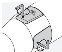
2. Dækslerne på højde- og sideindstillingen kan skrues af med den medfølgende torxskruetrækker (TX 6). I åben tilstand kan man justere højde- og sideindstillingen med indstillingsværktøjet.
