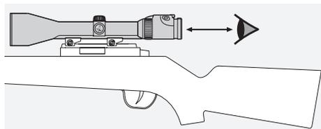
Tenez compte de la distance oculaire imposée si une lunette de visée est installée sur l'arme (voir fiche signalétique technique pour les mesures).
