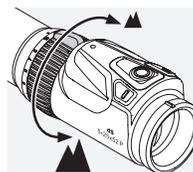
Girando l'anello di regolazione dell'ingrandimento di 180° è possibile regolare l'ingrandimento a piacimento. La scala sull'anello di regolazione consente una facile e comoda lettura della regolazione.
