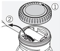
1. Abra la tapa de la batería y extraiga el destornillador tipo Torx y la herramienta de ajuste.
