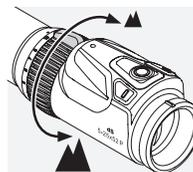
En tournant la bague de réglage du grossissement à 180°, vous obtenez graduellement le grossissement de votre choix. La graduation oblique permet de lire le réglage facilement et aisément. Pour faciliter l'orientation, le revêtement souple et rainuré de la bague de réglage est doté d'un taquet. Lorsque le grossissement est modifié, la position du point de visée et des repères de dérive s'adapte quasiment simultanément.
