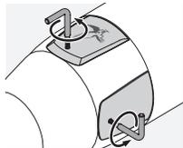
2. Las tapas del reglaje vertical y horizontal se pueden abrir con el destornillador tipo Torx suministrado (TX 6). Cuando estén abiertas, puede configurar el reglaje vertical y horizontal con la herramienta de ajuste.
