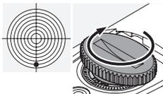
a) ... bei einem Tiefschuss im Uhrzeigersinn oder
