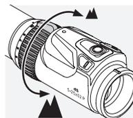
Door de vergrotingssteling 180° te draaien kunt u de gewenste vergroting traploos instellen. De schaal op de steling maakt een eenvoudig en praktisch aflezen van de instelling mogelijk. Voor een betere oriëntering heeft de zachte, geprofileerde stelingomhulling een neusje. Als de vergroting wijzigt, worden ook de posities van het richtpunt en de breedtemarkering bijna gelijktijdig aangepast.
