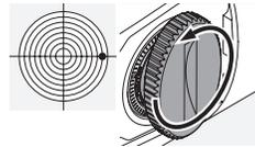
b) ... bei einem Rechtschuss gegen den Uhrzeigersinn entsprechend der Treffpunkt-korrektur (1/4 MOA; 7 mm auf 100 m).
