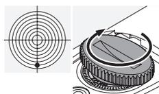
a) ... en cas d'impact bas, dans le sens des aiguilles d'une montre ou
