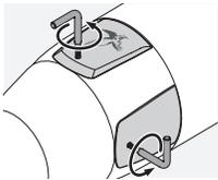
2. Die Abdeckungen der Höhen- und Seitenverstellung lassen sich mit dem beigelegten Torxschlüssel (TX 6) aufdrehen. Im geöffneten Zustand können Sie dann mit dem Stellwerkzeug die Höhen- und Seitenverstellung vornehmen.
