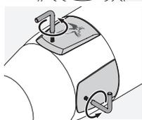
2. Vous pouvez ouvrir les caches des réglages vertical et latéral à l'aide du tournevis Torx (TX 6) joint. Lorsqu'ils sont ouverts, vous pouvez alors effectuer les réglages vertical et latéral avec l'outil de réglage.
