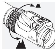
Suurennossuhdetta voidaan säätää kiertämällä portaatonta suurennoksen säätöä 180 asteen verran. Säätörenkaassa oleva asteikko mahdollistaa yksinkertaisen ja mukavan
