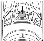
Premendo il pulsante di misurazione compare un cerchio luminoso, il bersaglio, e viene attivata la funzione di misurazione. Quando si rilascia il pulsante, comincia la misurazione.
