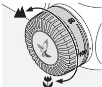
Con la torretta parallasse è possibile regolare la nitidezza ottimale per qualsiasi distanza di puntamento evitando così errori di mira dovuti a parallasse. La torretta di parallasse può
