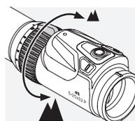
Путем поворота маховика фокусировки на 180° плавно изменяется кратность увеличения. Благодаря наклонной шкале на маховике фокусировки обеспечивается простое и комфортное считывание значений настройки. Для лучшей ориентировки маховик с мягким ребристым покрытием имеет выступ. При изменении увеличения положение точки прицеливания и отметку поправки на ветер изменяется практически одновременно.
