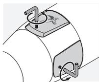
2. Крышки механизмов коррекции по высоте и боковой коррекции отвинтите с помощью прилагаемой отвертки Torx (TX 6). После этого при открытых крышках с помощью установочного инструмента выполните коррекцию по высоте и боковую коррекцию.
