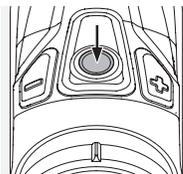
Si pulsa el botón de medición, aparecerá un círculo iluminado y se activará la función de medición. Si suelta el botón de medición, la medición comenzará y aparecerá el punto de impacto, calculado en base a los datos intro-
