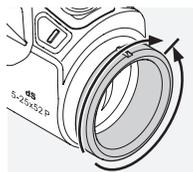
Индивидуальная настройка резкости прицельной марки выполняется путем обычного поворота маховика диоптрийной настройки. Сначала поверните маховик диоптрийной настройки влево (против часовой стрелки), затем вправо, пока не будет установлена оптимальная резкость прицельной марки. Если резкость прицельной марки установлена, то и изображение на дисплее тоже будет резким.
