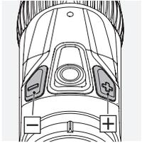
Kun hiusristikon valo on syttynyt, voit säätää kirkkautta +/- -painikkeella ja valita haluamasi asetuksen 64 kirkkaustasosta. Optimaalisen kirkkauden nopeaan löytämiseen painiketta voidaan pitää painettuna (kestopulssi), suorita hienosäätö painikkeiden kertapainalluksella (yksittäispulssi).
