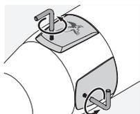
2. De afdekkingen van de hoogte- en breedtever- stelling zijn met de meegele- verde torx-schroevendraai- er (Tx 6) los te draaien. In geopende toestand kan vervolgens met het gereedschap de hoogte- en breedteverstelling wor- den uitgevoerd.
