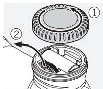
1. Öppna batteriluckan och ta ut torxnyckeln och inställningsverktyget.
