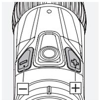
När hårkorsbelysningen är tänd, kan man justera ljusstyrkan med +/- knapparna, och välja bland 64 ljusstyrkenivåer. För att snabbt finna optimal ljusstyrka kan man hålla knappen intryckt (lång
