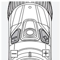
Una volta che l'illuminazione del reticolo è accesa, è possibile regolare la luminosità mediante i tasti +/- e selezionando l'impostazione desiderata fra 64 livelli di luminosità.
