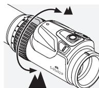
Ved at dreje forstørrelsesringen 180° kan den ønskede forstørrelse indstilles trinløst. Skalaen på forstørrelsesringen muliggør en nem og komfortabel aflæsning af indstillingen. For at lette orienteringen har det bløde, riflede overtræk på forstørrelsesringen en fingerknop. Når forstørrelsen ændres, tilpasser sigtepunktets og vindmarkeringernes position sig samtidigt.
