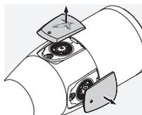
3. Hoogteverstelling: Draai met het gereedschap naar het midden van de hoogteverstelling...
