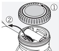
1. Откройте крышку отсека для батареи и выньте отвертку Torx и установочный инструмент.
