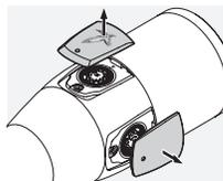
3. Коррекция по высоте: установочным инструментом поверните в центре механизма коррекции по высоте...
