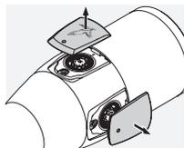
3. Regolazione dell'altezza: far ruotare il centro della regolazione dell'altezza con l'utensile di regolazione...
