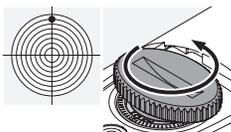
b) ... bei einem Hochschuss gegen den Uhrzeigersinn entsprechend der Treffpunkt-korrektur (1/4 MOA; 7 mm auf 100 m).
