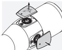
3. Reglaje vertical: Gire la herramienta de ajuste en el centro del reglaje vertical...
