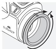
Din individuelle indstilling til opnåelse af optimal skarphed for sigtet kommer i stand ved en enkel drejning af dioptri-justeringsringen. Drej først dioptri-justeringsringen helt til venstre (mod uret) og derefter til højre, indtil sigtet viser optimal skarphed. Når sigtet er stillet skarpt, er displayet også stillet skarpt.
