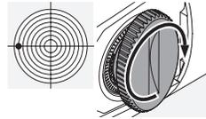
a) ... bei einem Linkschuss im Uhrzeigersinn oder
