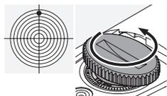
б) ... против часовой стрелки, если точка попадания располагается выше (1/4 угловой минуты; 7 мм на 100 м).
