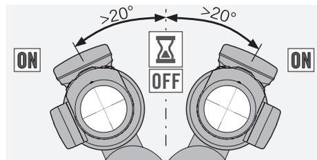
Na 40, 60 of 80 seconden (tijdsduur instelbaar in de app) schakelen de dradenkruisverlichting en het display uit. 10 seconden daarvoor verschijnt een waarschuwingssymbool. Voor verlenging van de weergave met de ingestelde tijdsduur, moet de +/-knop worden ingedrukt of de dS 20 graden naar links of rechts worden gekanteld. Als het display is uitgeschakeld, moet ter activering de meetknop opnieuw worden ingedrukt.
