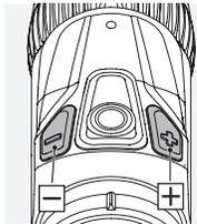
Une fois l'éclairage du réticule allumé, vous pouvez maintenant régler la luminosité au moyen de la touche +/- et sélectionner le niveau souhaité entre 64 niveaux de luminosité.
