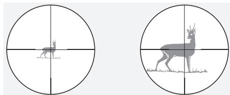
Cambiando l'ingrandimento, il reticolo mantiene le stesse dimensioni: vengono ingrandite le dimensioni dell'immagine, ma non del reticolo né del display. Anche con notevoli ingrandimenti, l'obiettivo viene coperto solo in misura minima.
