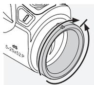
Pour obtenir l'image la plus nette du réticule, il vous suffit de tourner la bague de réglage de la dioptrie. Tournez la bague de réglage de la dioptrie entièrement vers la gauche (dans le sens inverse des aiguilles d'une montre) puis vers la droite, jusqu'à ce que le réticule soit le plus net possible. L'afficheur est également net lorsque le réglage de netteté du réticule est effectué.
