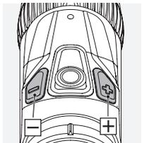
Una vez encendida la iluminación de la retícula, puede ajustar la luminosidad con los botones +/- y seleccionar el ajuste que prefiera entre 64 niveles de luminosidad. Para cambiar rápidamente de intensidad, puede mantener pulsado el botón (impulso continuo). Para realizar el ajuste de precisión, puede pulsar una vez el botón (impulso único).
