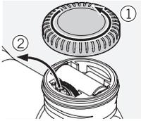
1. Öffnen Sie den Batteriedeckel und entnehmen Sie den Torxschlüssel und das Stellwerkzeug.
