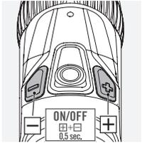
Drücken Sie zum Einschalten der Absehensbeleuchtung gleichzeitig die Plus- und Minustaste eine halbe Sekunde lang.
