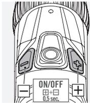
Pour allumer l'éclairage du réticule, appuyez simultanément sur les boutons plus et moins pendant une demi-seconde.
