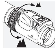
Durch Drehen des Vergrößerungsstellrings um bis zu 180° können Sie die gewünschte Vergrößerung stufenlos einstellen. Die Skala am Stellring ermöglicht ein einfaches und
