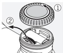
1. Open het batterijdek- sel en verwijder de torx- schroevendraaier en het gereedschap.
