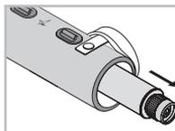
Возьмитесь одной рукой за корпус трубы вблизи объектива, другой рукой – за окуляр. Вытяните внутреннюю трубу до упора.
