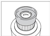
Durch Stülpen der Augenmuscheln steht auch dem Brillenträger das große Sehfeld optimal zur Verfügung. Zur Reinigung oder zum Austausch können Sie die Augenmuscheln abschrauben.
