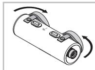
Objektiv und Okular sind durch Kappen gegen Verschmutzung und Beschädigung geschützt.
