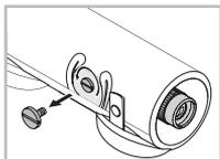
De statiefvoet heeft een aansluitschroefdraad van 3/8" UNC. De aangebrachte opzetschroef reduceert de aansluitschroefdraad tot 1/4" UNC. Hierdoor pas de uittrekbare telescoop op elk gangbare statief.
