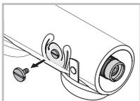
Stativfoden har et påskruningsgevind på 3/8" UNC. Den indsatte skrue reducerer påskruningsgevindet til 1/4" UNC. Udtrækskikkerten passer derfor til alle gængse stativer.
