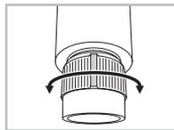
Durch Drehen des Okulars können Sie jedes Objekt in einer Entfernung von 10 m bis unendlich scharf stellen. Bei unendlich zeigt die kleine Nase am Okular nach oben.
