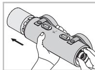
Так как защитный чехол идеально соответствует размеру корпуса Вашей телескопической трубы, поэтому небольшой эффект слипания защитного чехла с корпусом может произойти с течением времени. Удаление защитного чехла может быть произведено путем удержания телескопической трубы одной рукой и нажатием на корпус, толкая со стороны окуляра другой рукой.
