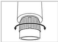
Door draaien van het oculair kunt u elk object op een afstand van 10 m tot oneindig scherp stellen. Bij oneindig wijst het kleine neusje op het oculair naar boven.
