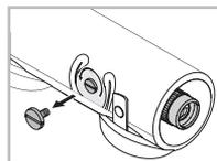
Der Stativfuß verfügt über ein Anschlussgewinde von 3/8" UNC. Die eingesetzte Überschraube reduziert das Anschlussgewinde auf 1/4" UNC. Das Ausziehfernrohr passt somit auf jedes gängige Stativ.
