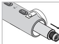
Halten Sie das Ausziehferrohr am Grundkörper und am Okular fest. Ziehen Sie den Auszug bis zum Anschlag vollständig heraus.
