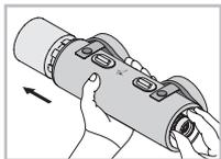
Beskyttelseshylsterets størrelse er perfekt dimensioneret til at passe dit teleskop, en svag vedhængende-effekt mellem beskyttelseshylsterets og det udtrækkelige teleskop kan forekomme gennem tiden. Afmontering af beskyttelseshylsteret kan bedst opnås ved at holde teleskopet med den ene hånd og skubbe det udtrækkelige teleskop fra okulars side fremad og ud af beskyttelseshylsteret.
