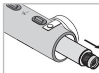
Sujetar el telescopio extensible por el cuerpo base y por el ocular. A continuación, extraer hasta su tope la parte extensible.
