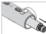
Maintenez la longue-vue télescopique à hauteur du corps central et de l'oculaire. Sortez entièrement la partie extensible jusqu'à la butée.
