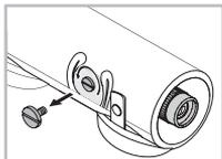
Il piedino del cannocchiale si fissa ad un attacco filettato da 3/8" UNC. La vite inserita riduce l'attacco filettato a 1/4" UNC. Pertanto il cannocchiale da osservazione è adatto per ogni treppiede convenzionale.
