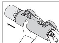
Då skyddet är skraddarsytt för att passa det utdragbara teleskopet perfekt, kan det ibland vara besvärligt att få ut den ur skyddet. Bästa sättet att få ut ett utdragbart
