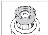
Door omplooiën van de oogkleppen heeft ook een bril drager het grote gezichtsveld optimaal ter beschikking. U kunt de oogkleppen eraf schroeven om ze te reinigen of te vervangen.
