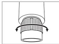
Al girar el ocular, puede enfocar nítidamente cualquier objeto desde una distancia de 10 m hasta el infinito. En la posición «infinito» la muesca del ocular
