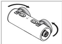
Objektiv og Okular er beskyttet mod snavs og beskadigelse med kapper. Kapperne kan skubbes til side for at iagttage – uden at åbne trykknapperne.
