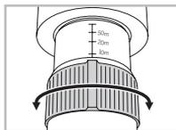
Op het oculair bevindt zich een afstandsschaal. Hierdoor is het eenvoudiger snel op de gewenste afstand in te stellen. Bovendien maak de schaal een grove schatting van de afstand mogelijk.
