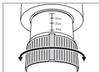
L'oculare è provvisto di scala per individuare rapidamente la messa a fuoco ideale in base alla distanza dell'oggetto osservato.
