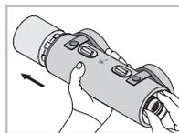
Como la funda de campo se ajusta perfectamente a su telescopio puede aparecer un ligero efecto de adherencia entre la funda y el telescopio. Podemos retirar la funda de campo más fácilmente si sujetamos el telescopio con una mano y lo apretamos hacia delante desde el lado del ocular hasta retirar la funda de campo.
