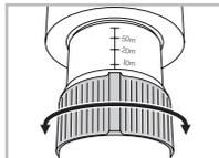
På okularet er der en afstandsskala. Den hjælper dig med hurtigt at indstille kikkerten til den ønskede afstand. Ligeledes gør skalaen det muligt at foretage en mere eller præcis afstandsbedømmelse.
