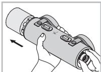
Omdat de stay-on case perfect op maat gemaakt is van uw telescoop, kan er met de tijd een klein hechtingseffect ontstaan tussen de stay-on case en uw uitschuifbare telescoop. U kan de stay-on case het best verwijderen door de uitschuifbare telescoop in de ene hand te houden en met de andere hand het oculairgedeelte vooruit te duwen, uit de stay-on case.
