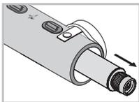
Houd de uittrekbare telescoop bij het basisinstrument en het oculair vast. Trek het uittrekbare gedeelte er tot de aanslag volledig uit.
