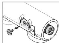
El pie del telescopio dispone de una rosca de 3/8" UNC. El tornillo adaptador reduce la rosca a 1/4" UNC de forma que el telescopio de observación puede emplearse con cualquier trípode.
