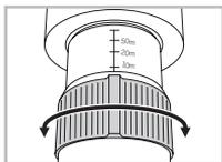
Am Okular befindet sich eine Entfernungsskala. Sie hilft Ihnen, rasch auf die gewünschte Entfernung einzustellen. Ebenso ermöglicht die Skala eine grobe Abschätzung der Entfernung.
