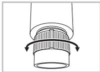
Girando l'oculare potete mettere a fuoco qualsiasi oggetto ad una distanza da 10 m fino all'infinito.
