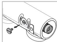
La pièce de raccord au trépied est équipée d'un filet de raccord de 3/8" UNC. La vis de recouvrement intégrée réduit le filet de raccord à 1/4" UNC. Le télescope s'adapte ainsi à tous les trépieds usuels.
